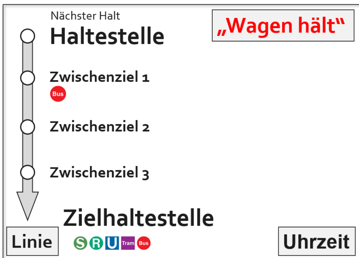
Abbildung 1: Abfolge der nächsten Haltestelle mit Zwischenzielen und Zielhaltestelle. Statt „Wagen hält“ kann auch „Stop“ angezeigt werden.
