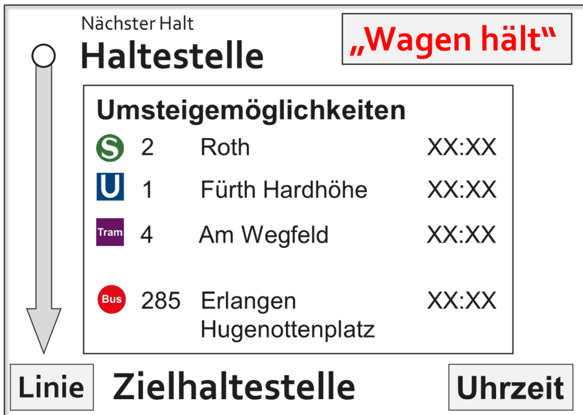
Abbildung 3: Darstellung mit Umsteigemöglichkeiten an der nächsten Haltestelle ohne Zwischenziele. Kann alternierend mit Abbildung 2 erfolgen.
